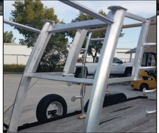
D-Tube/Frame x 24' 6063-T52 52-63-14617W (NC) 3.365 x 2.335
